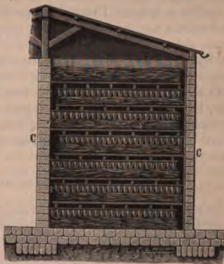
Fig. 250. — Fabrication de la céruse (procédé hollandais).
